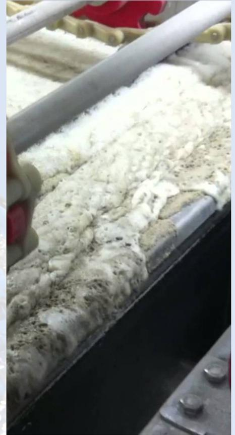
El resultado final es una mezcla de espuma flotante de agua, vapor y partículas que se pueden desnatar en la parte superior del tanque. Por lo tanto, los materiales se pueden eliminar o utilizar en el futuro, y al mismo tiempo se limpian las aguas residuales.
